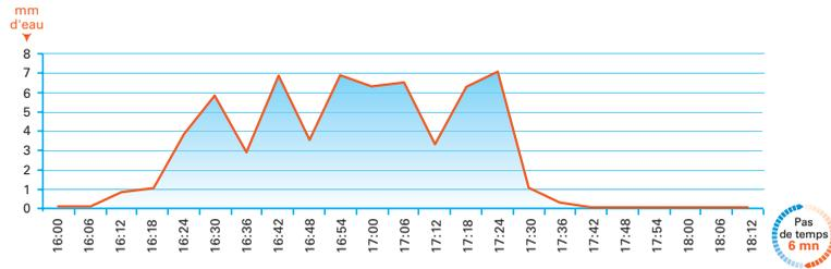
Pluies d'été courtes et intenses, d'une période de retour supérieure à 10 ans. L'intensité maximale est constatée entre 16 et 18 h, avec une hauteur d'eau cumulée de plus de 6 cm en 2 heures. Très localisée, elle a créé d'importants dégâts sur la commune de Genay alors qu'aucune pluie n'a été enregistrée à Neuville sur Saône.
